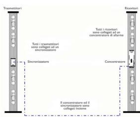
Più concentratori possono essere collegati ad una unità di controllo perimetrale (MIND) attraverso un cavo BUS dati ed alimentazione.
