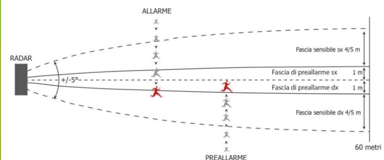
Il **Radar 077 Wide** crea un'area volumetrica sensibile con raggio di 40 metri sulla linea dei 3db (90°).
